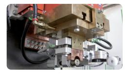
Standardmaschinen mit Sonderschweisswerkzeug
