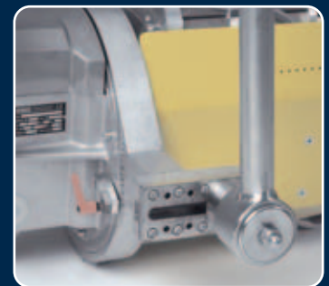
Kardanaufhängung mit Feststellmöglichkeit und einstellbarem Schwerpunkt
