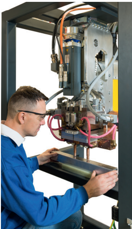
1: Tobias Broda an der Versuchsanlage. Gemeinsam mit NIMAK hat er ein einseitiges Punktschweißsystem mit thermoexpansionsbasierter Prozessregelung entwickelt Foto: SLV Halle GmbH
