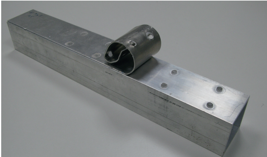
4: Die Abschälprüfung belegt die Qualität der einseitigen Punktschweißung: Deren Festigkeit liegt über der Grundfestigkeit des Werkstoffs Foto: SLV Halle GmbH
