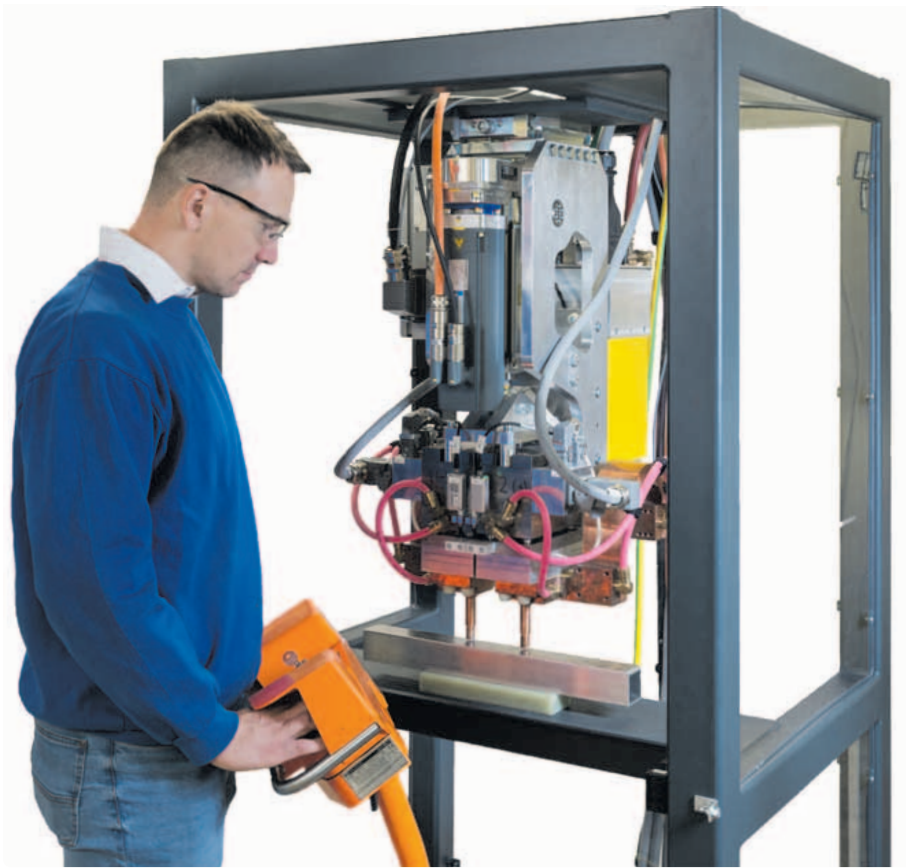
Tobias Broda, bis Ende des vergangenen Jahres Fachbereichsleiter Pressschweißen bei der SLV Halle, an der Versuchsanlage. Gemeinsam mit NIMAK hat er ein einseitiges Punktschweißsystem mit thermoexpansionsbasierter Prozessregelung entwickelt
