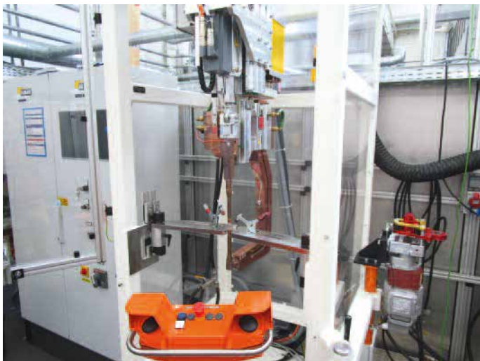
Die Versuchsanlage bei Volkswagen: Seit mehr als einem Jahr erzielen die Schweißversuche mit den oszillierenden Elektroden auf Basis der „magneticDRIVE“-Technologie von Nimak beeindruckende Ergebnisse. (Bild: Volkswagen AG)
