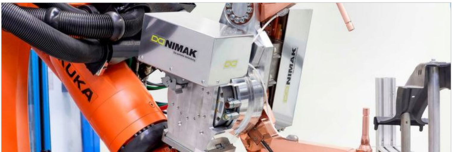
Die Galaxy Gun stellt ein völlig neues Konzept dar: Der Grundkörper, das Galaxie-Antriebssystem und die Zangenarme sind in einem wesentlich kompakteren und etwa 20 % leichteren Modul vereint. (Wittenstein)
