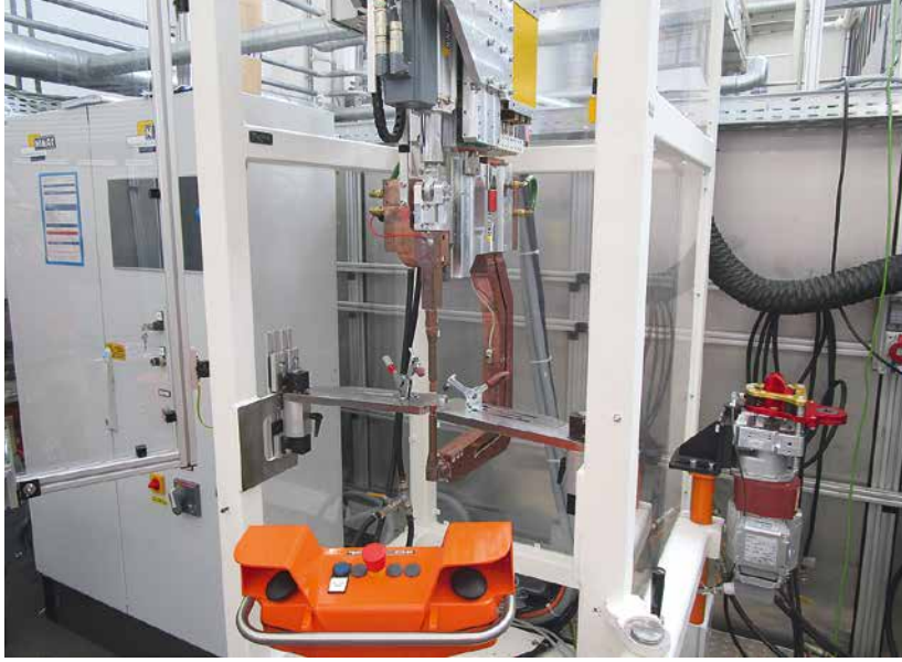
Die Versuchsanlage bei Volkswagen für die Schweißversuche mit den vibrierenden Elektroden auf Basis der Magnetic-Drive-Technologie.
