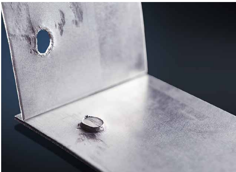
Die Ausknöpfversuche zeigen, dass Buckelschweißen von Aluminium mit „Magnetic Drive“ möglich ist.
