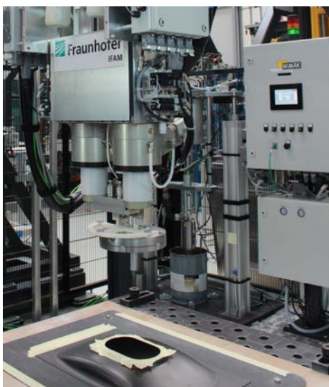
Abb. 1: Die von NIMAK, QUISS und Fraunhofer entwickelte Klebstoff-Applikation setzt neue Maßstäbe nicht nur in der Luft- und Raumfahrtindustrie. Foto: NIMAK GmbH
