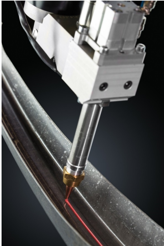
Abbildung 2: Klebstoffaufbringung Auftragskopf mit Kupferdüse Foto: NIMAK GmbH
